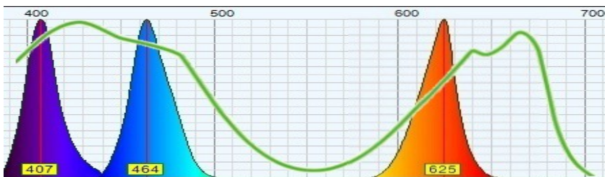
Émission de LED's UV, Bleue et rouge superposée à la courbe d'efficacité de la photosynthèse
