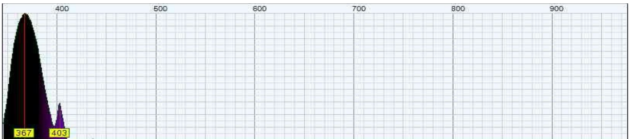
Spectre d'un tube fluorescent marqué “BLB” (BL pour "black light" et le B pour "black")
