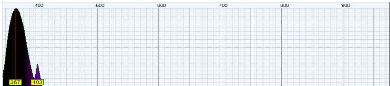
Spettro di un tubo fluorescente marcato "BLB" (il BL sta per "black light" e il B sta per "black")
