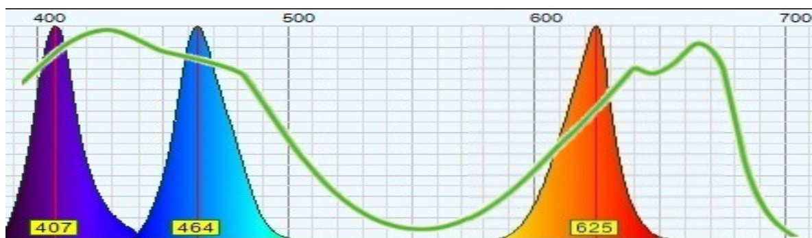
Emissione dei led ultravioletti, blu e rossi con sovrapposta la curva di efficienza della fotosintesi
